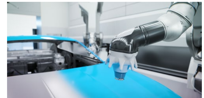
Mit der EcoBell4 und der 4-Hauptnadel-Technik wird der Farbwechsel zum Sekundenspiel – bei niedrigsten Lack- und Spülmittelverlusten.
